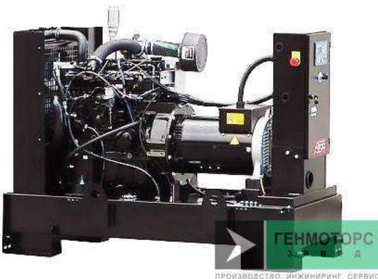
Дизельные генераторы FOGO FDF40MS (номинальной мощностью 32 кВт и частотой 50 Гц) изготавливаются на основе оригинального японского дизельного мотора Mitsubishi S4S-DT61SD, и предназначены для производства 3-хфазного электрического тока напряжением 400 В. Использование надежного и ремонтопригодного дизельного мотора Mitsubishi S4S-DT61SD в суровых условиях эксплуатации с высочайшим качеством электрической энергии синхронных генераторов Sincro (Италия), является наиболее
