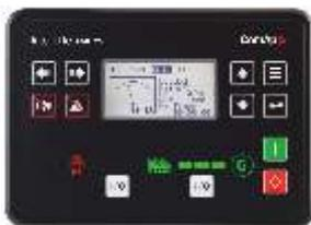
**Контроллер ДГУ IntelliLite AMF25** предназначен для управления одной дизель-генераторной установкой (в том числе оборудованной электронным блоком управления), с функцией слежения за сетью (AMF). Контроллер производит автоматический пуск ДГУ при пропадании сети. Постоянный контроль сети позволяет своевременно переходить на сетевое питание с последующим остановом ДГУ.
